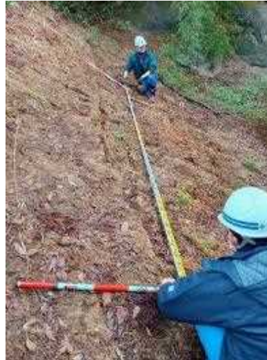
ため池堤体の亀裂等の変状及び洪水吐等の損傷確認
